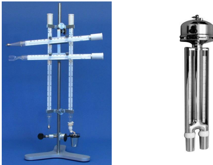
Слика 3. Конвенционален сет на термометри и Асманов аспирационен психрометар
